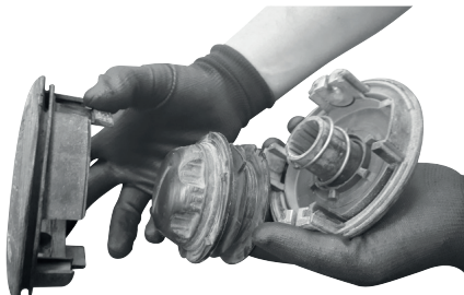
Figura 16 – Abriendo el carrete de nylon
