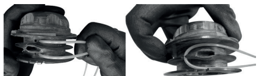
Figura 17 – Passando o fio de nylon
