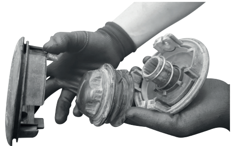
Figura 16 – Abrindo o carretel de nylon
