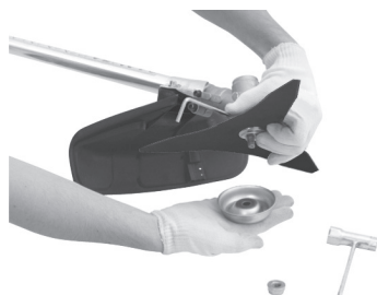
Figura 11 – Colocando a flange externa
