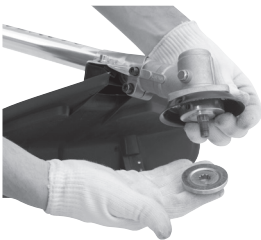
Figura 14 – Montagem da flange externa
