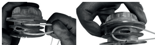
Figura 17 – Pasando el hilo de nylon
