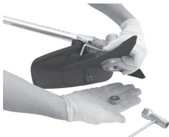
Figura 12 – Finalizando a montagem da lâmina
