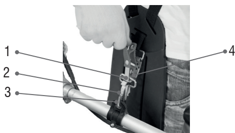
Figura 27 – Fixando a roçadeira ao cinto
