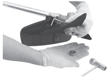
Figura 12 – Finalizando el montaje de la lámina
